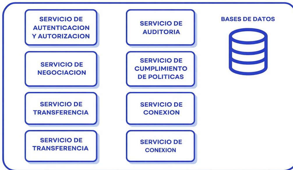
Ilustración 25: Componentes fundamentales del conector
